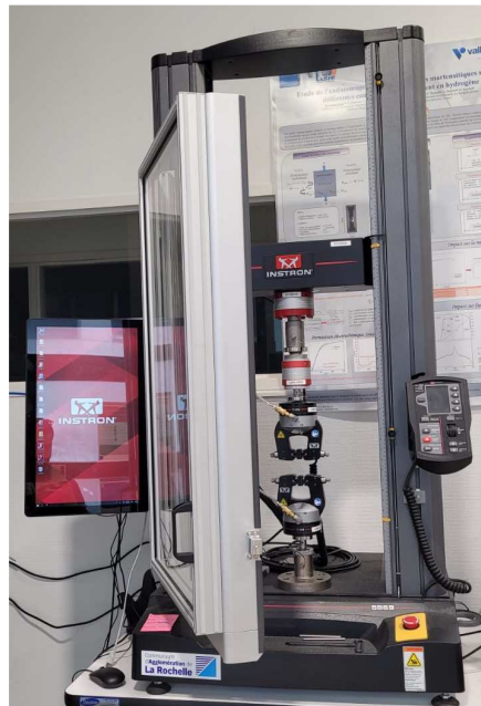
Figure II- 8 : Appareil de l'essai de traction Instron TM 5969
