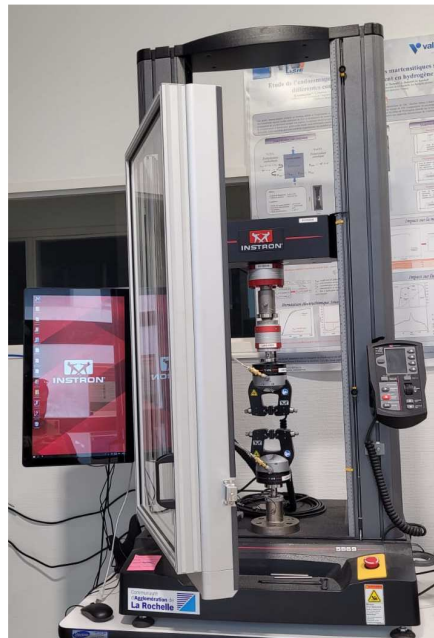
Figure II- 8 : Appareil de l'essai de traction Instron TM 5969
