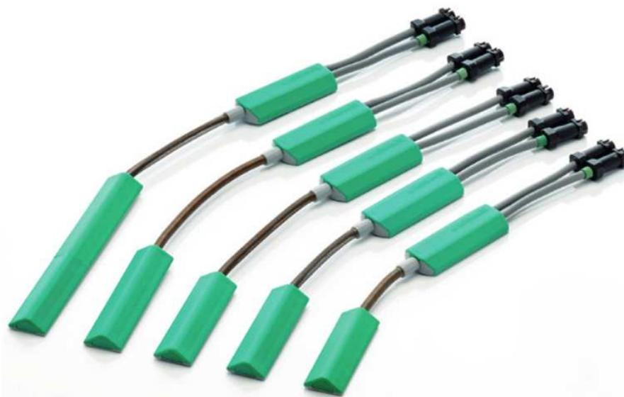
**Figure 12. Electrogoniomètre Biometric Ltd.**
