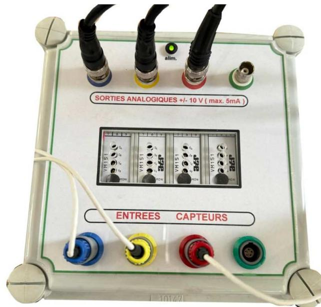
**Figure 77. Amplificateur pour 3 accéléromètres.**
