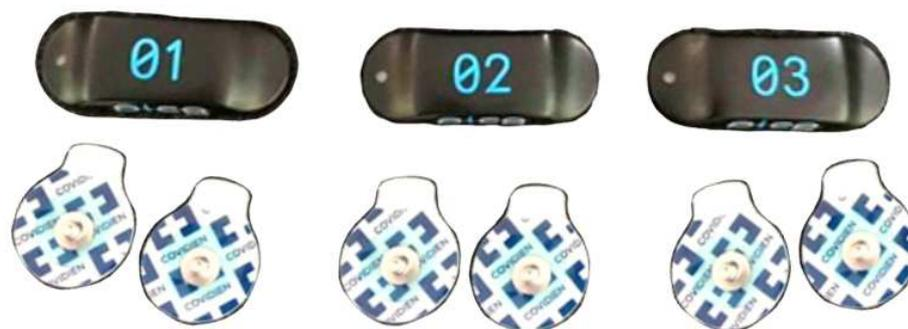
**Figure 28. Trois électrodes EMGs sans fils non-invasive Cometa®.**
