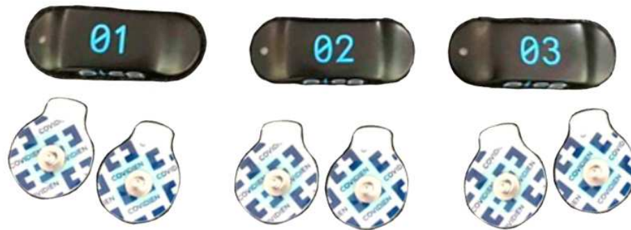
Figure 28. Trois électrodes EMGs sans fils non-invasive Cometa®. Tibialis anterior = 01, Soleus = 02, Gastrocnemius medius = 03.
