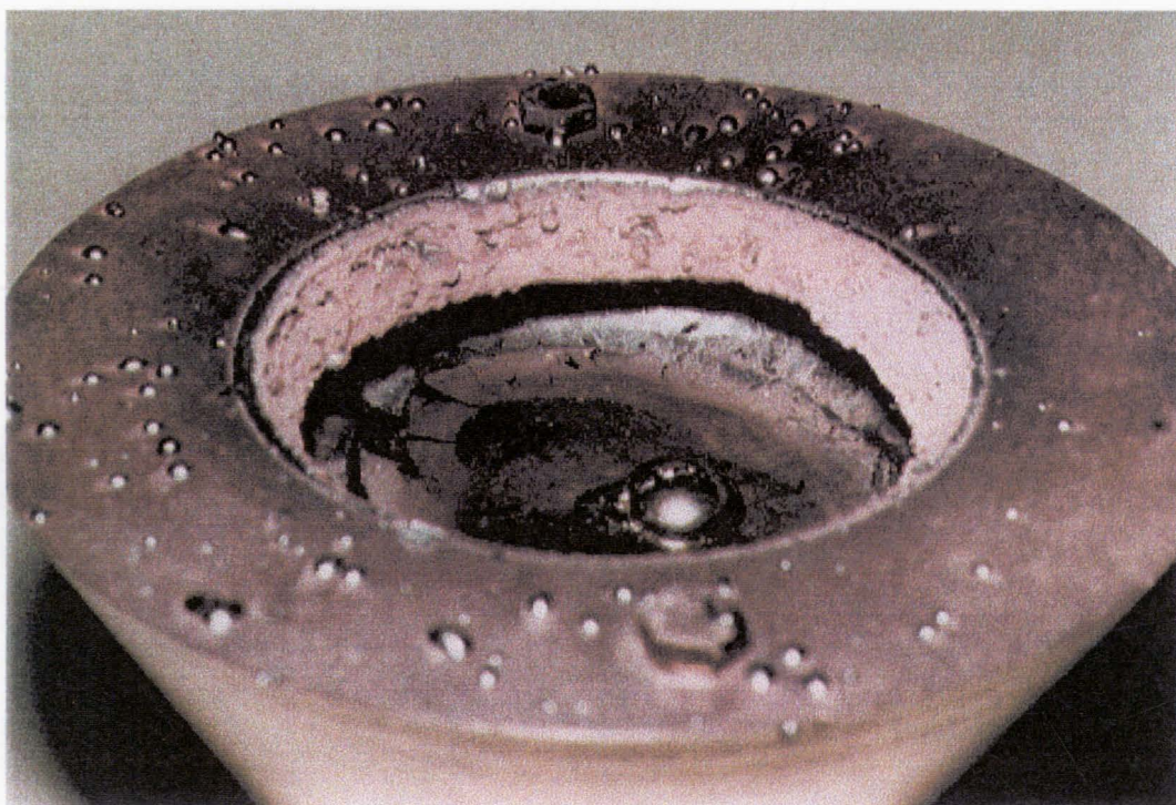
Schéma 10 : Insert de cuivre placé dans le 'creuset 2'. On observe en partie interne, une destruction partielle radiale de l'insert en surface, et un élargissement du bain de cérium.
