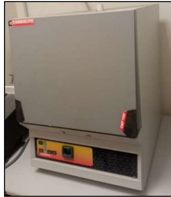
Figure 40 : Four électrique utilisé pour les traitements thermiques.
