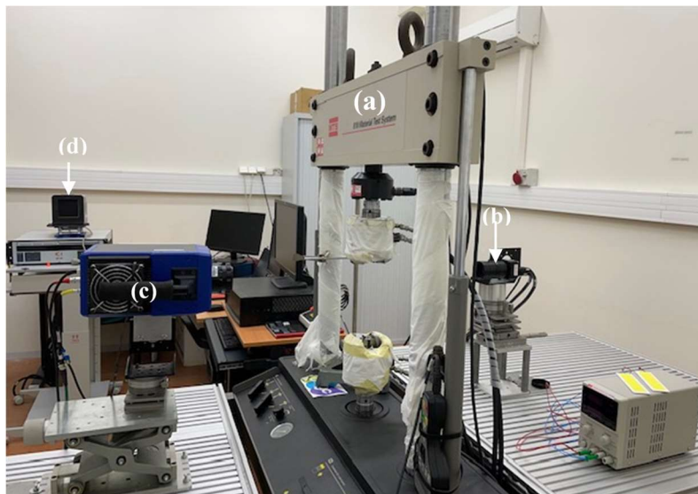
Figure 62: Dispositif expérimental : (a) machine MTS, (b) caméra visible, (c) caméra IR et (d) corps noir.
