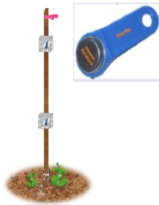
Figure 22 : dispositif terrain des microcapteurs ibutton
