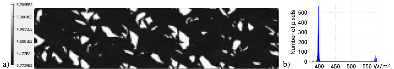
Figure 65 : Exittance thermique du sol ( W/m^2 de sol). a) Image. b) Histogramme. \epsilon_{sol} = 0.91 , T_{sol} [295.5K \ 325.5K] , \epsilon_{plante} = 1 et T_{plante} = 0K .
