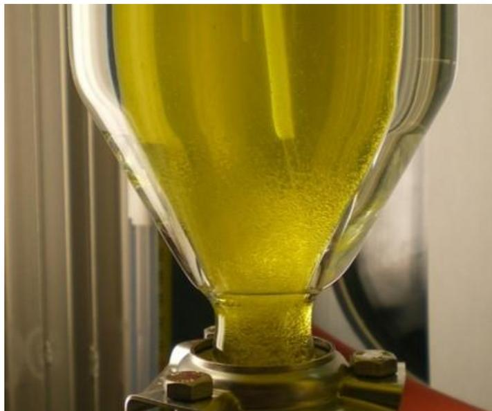
Figure 2-15 : Gouttes de phase lourde entraînées dans la zone de désengagement d'une colonne pulsée (colonne en FOC)
