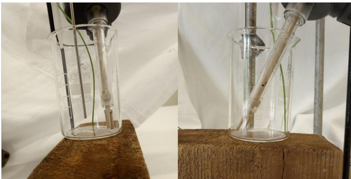
Figure 4-5 : Montage final pour les mesures en b cher agit , montrant la sonde de mesure (gris), la fibre optique de mesure de temp rature (vert) et l'agitateur.
