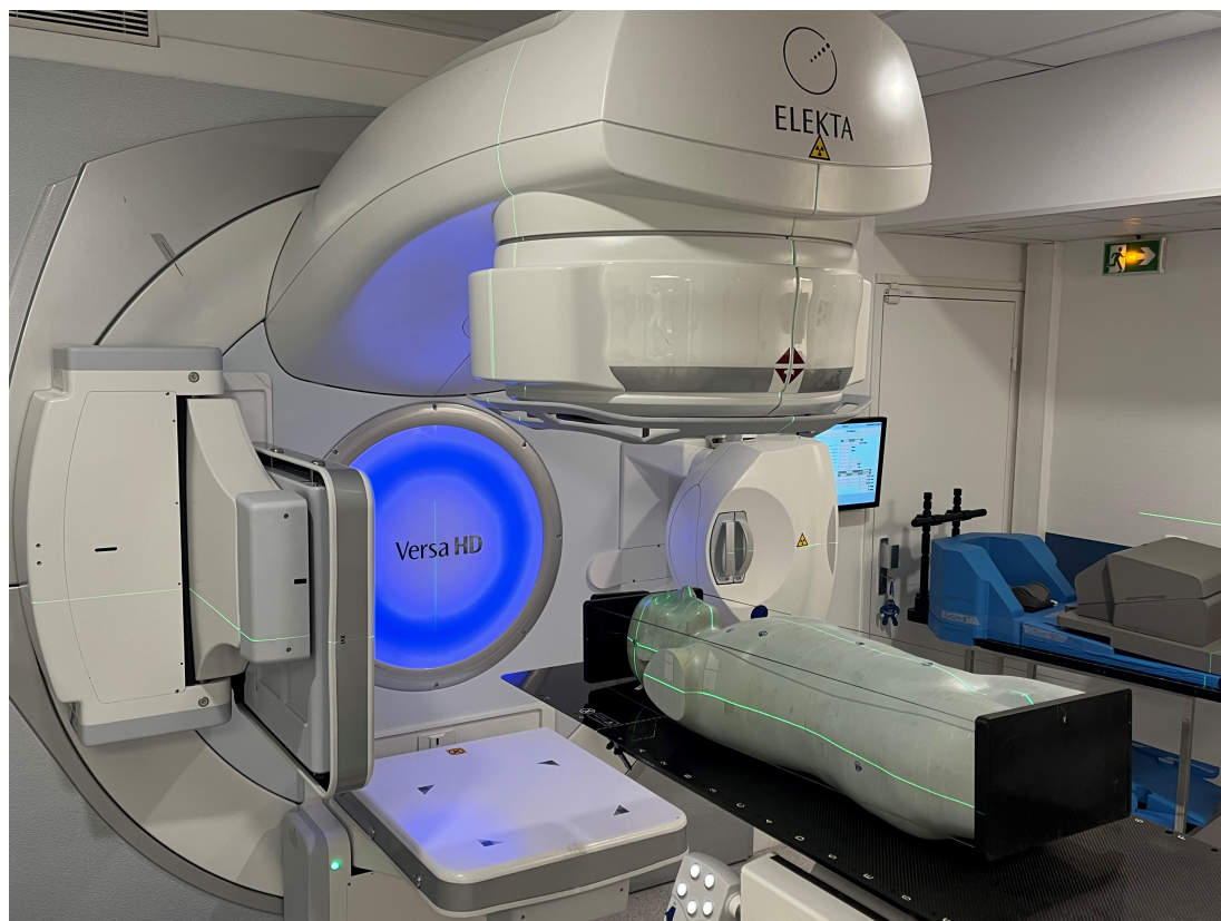
Figure 4.24 – Mise en place du fantôme anthropomorphe avec les 93 RPL placés dans le volume sur la table de l'accélérateur linéaire Versa HD prêt pour le tir.
