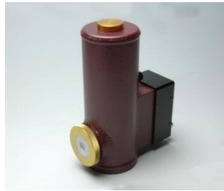
Fig. 1.14 : Détecteur IR refroidi à l'azote liquide développé par Hamamatsu [100]
