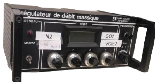
Fig. 5.11 : Régulateur de débit massique utilisé pour le contrôle des concentrations des mélange de gaz avant leur introduction dans la cellule fluidique
