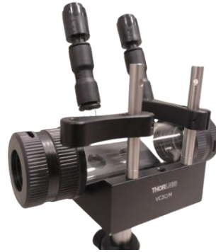
Fig. 5.18 : Tube en verre de 10cm de long utilisé pour les mesures de transduction en espace libre
