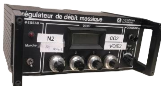
Fig. 5.11 : Régulateur de débit massique utilisé pour le contrôle des concentrations des mélange de gaz avant leur introduction dans la cellule fluidique
