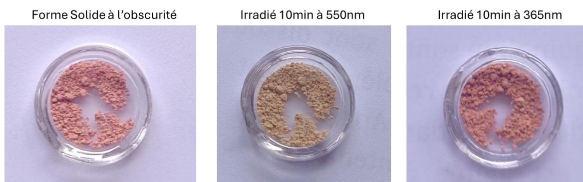
Photographies du (\text{SPPy})_4[\text{Mo}_8\text{O}_{26}].\text{CH}_3\text{CN} à l'obscurité, irradié à 550nm et irradié à 365nm
