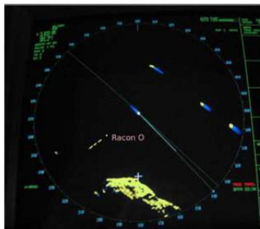
**Fig. 5 :** Affichage de la lettre 'O' sur l'écran d'un opérateur suite à la réponse d'un Racon
