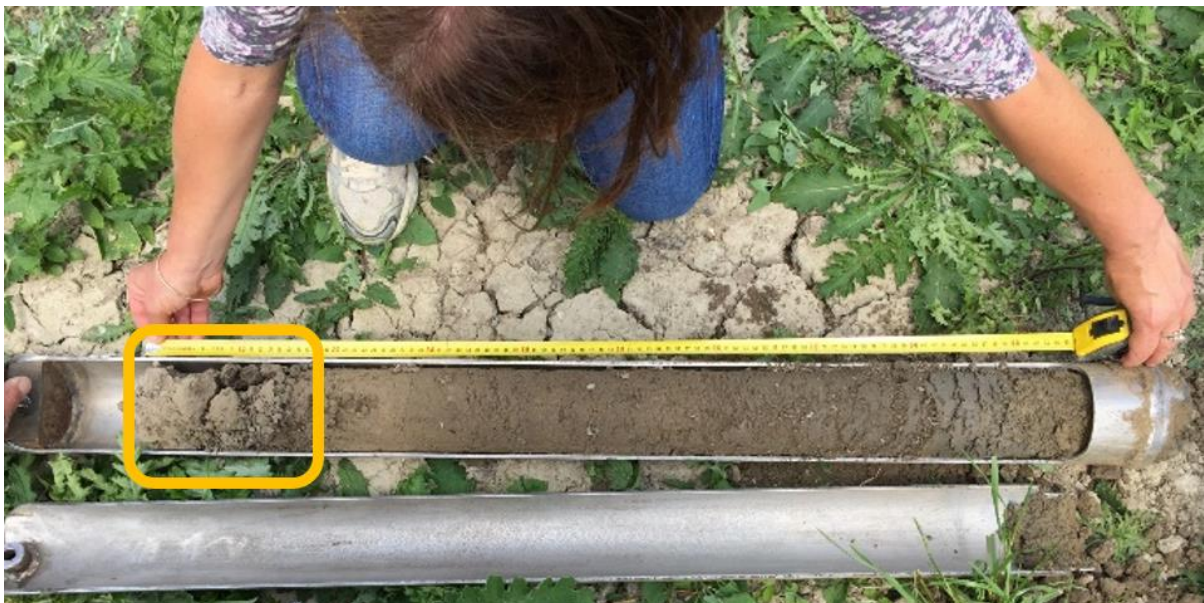
Figure 13: Carotte de sédiment prélevé à Bouafles présentant une zone labourée de 16 cm (rectangle jaune), photo de Sophie Ayrault.
