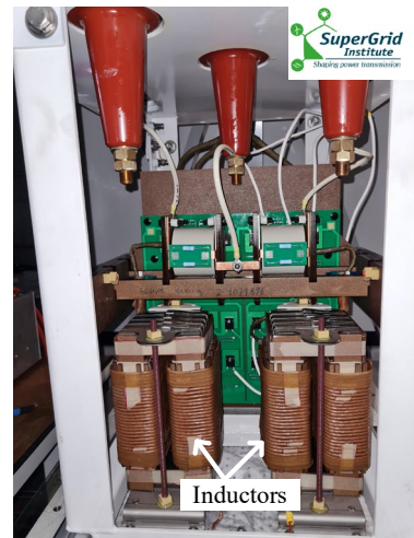
Implémentation du prototype de convertisseur DC-DC, haut) onduleur et cuve, milieu) ouverture de la cuve, bas) intérieur de la cuve avec de gauche à droite : MFT, PCB redresseur, condensateurs de sortie et inductances
