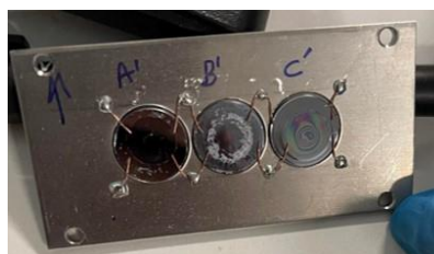
Figure II-1 : Photo du porte-échantillon utilisé pour l'irradiation des films de polymère sous faisceau d'électrons
