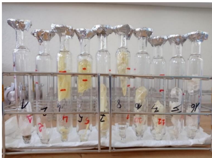
Figure II-3 : Photos d'ampoules en verre scellées contenant du polymère.
