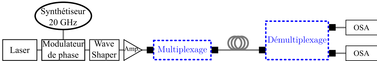
FIGURE 3.27. Représentation schématique de la configuration expérimentale utilisée pour réaliser l'expérience de mélange à quatre ondes sensible à la phase.
