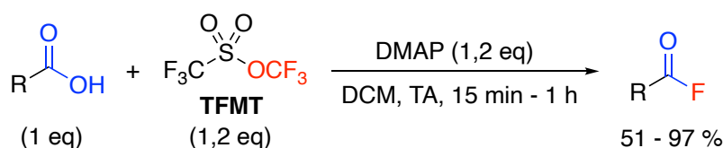
Schéma 48 : Synthèse de fluorures d'acide à partir de TFMT
