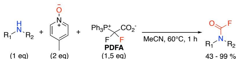
Schéma 18 : Synthèse de fluorures de carbamoyle à partir de difluorocarbène et d'une pyridine N-oxyde
