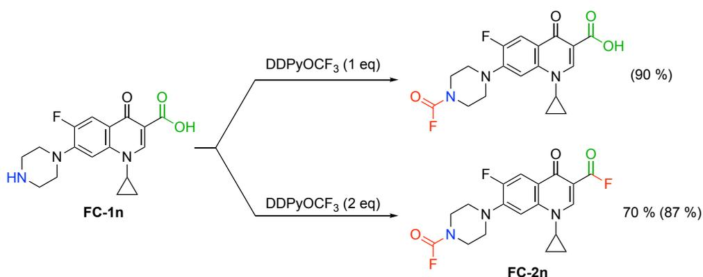
Schéma 6 : Fonctionnalisation de la Ciprofloxacine – Rendement isolé (rendement dosé par RMN <sup>19</sup>F avec PhOCF<sub>3</sub> comme étalon)
