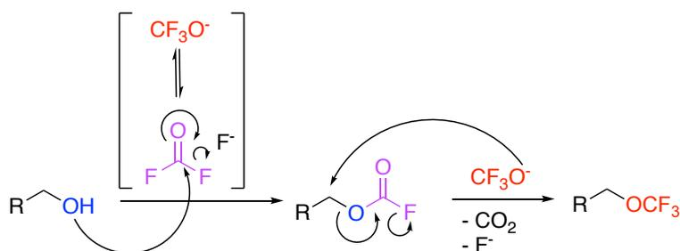
Schéma 7 : Mécanisme de la trifluorométhoxylation du décan-1-ol
