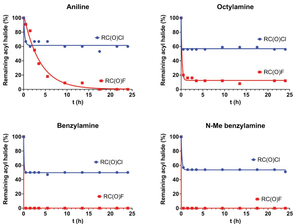
Figure 2 : Réactivité du fluorure d'acide **FA-2d** et de son analogue chloré avec différentes amines - suivi par RMN <sup>19</sup>F avec PhOCF<sub>3</sub> comme étalon – Condition : RCOX (1 eq), Amine (1 eq) dans CD<sub>3</sub>CN à TA
