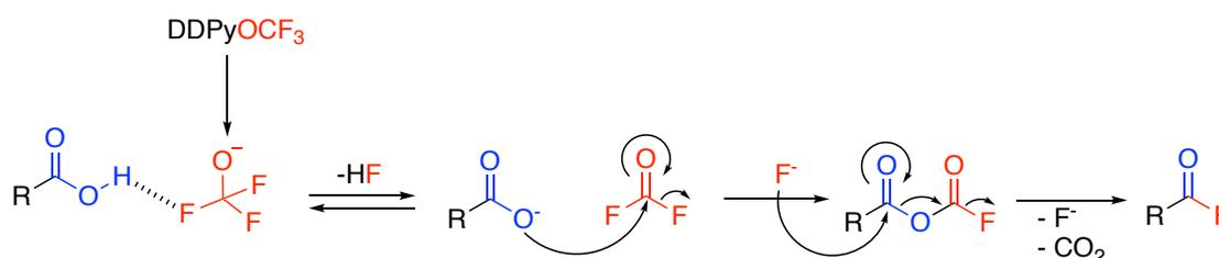
Schéma 2 : Mécanisme de la synthèse des fluorures d'acide à partir du **DDPyOCF<sub>3</sub>**
