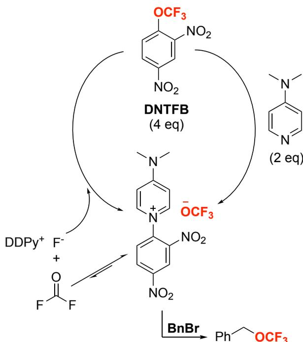
Schéma 1 : Hypothèse mécanistique de la trifluorométhoxylation à partir de **DDPyOCF<sub>3</sub>**
