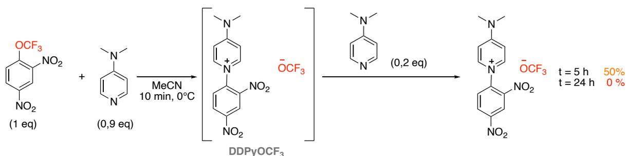
Schéma 7 : Test de dégradation du **DDPyOCF<sub>3</sub>** après ajout de 0,2 eq de **DMAP**, déterminé par RMN <sup>19</sup>F
