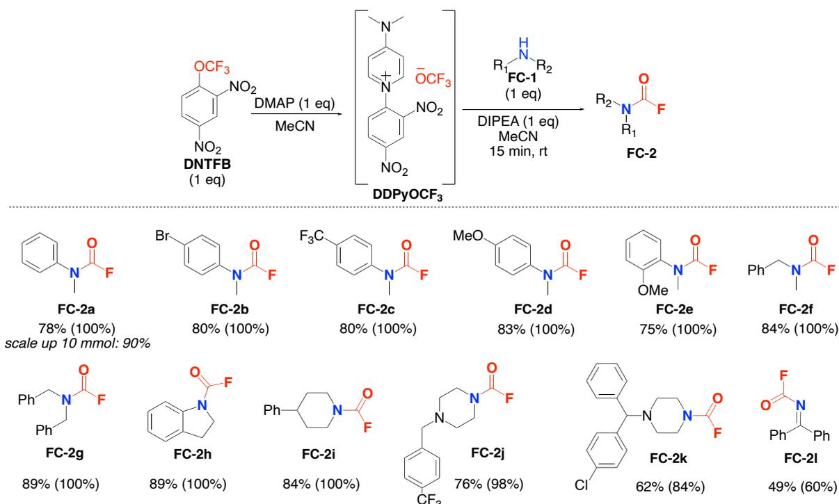
Schéma 5 : Exemplification de la synthèse des fluorures de carbamoyle – Rendement isolé (rendement dosé par RMN <sup>19</sup>F avec PhOCF<sub>3</sub> comme étalon)
