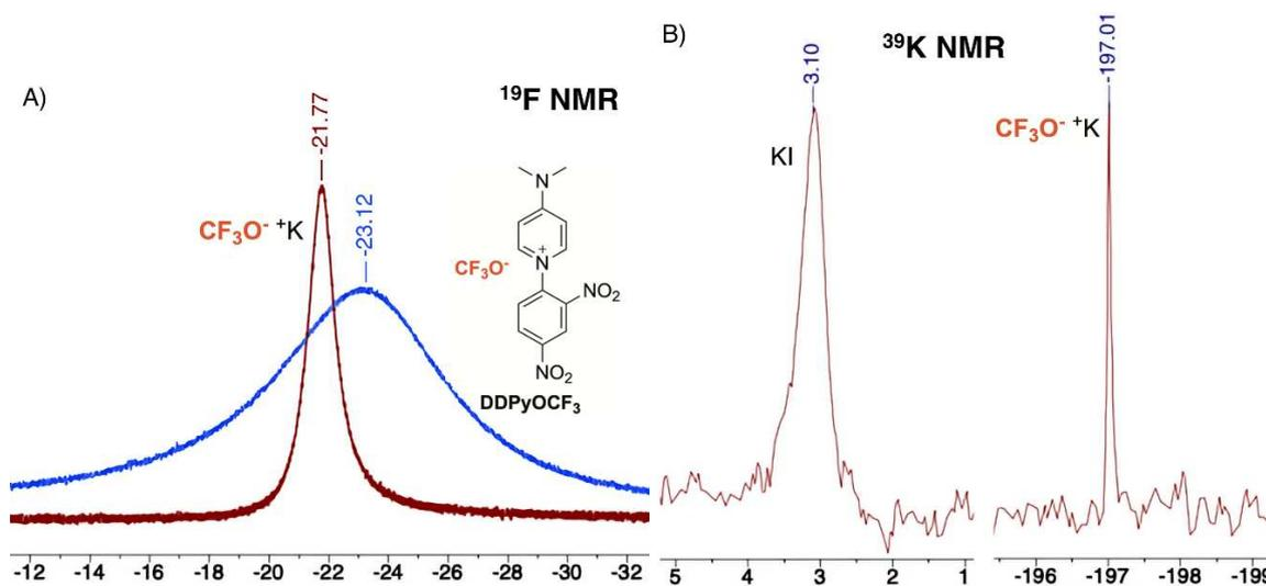
Figure 2 : A) RMN <sup>19</sup>F du **DDPyOCF<sub>3</sub>** et du **KOCF<sub>3</sub>** (**DDPyOCF<sub>3</sub> + KI**) B) RMN <sup>39</sup>K du **KI** et du **KOCF<sub>3</sub>** (**DDPyOCF<sub>3</sub> + KI**)
