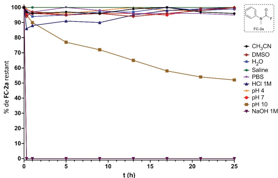
Figure 1 : Stabilité de **FC-2a** en milieux aqueux et dans les solvants – PBS : phosphate buffered saline – Suivi par RMN <sup>19</sup>F avec PhOCF<sub>3</sub> comme étalon
