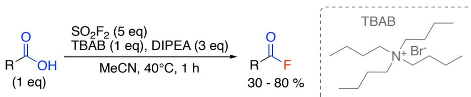
Schéma 38 : Synthèse de fluorures d'acide avec du fluorure de sulfuryle
