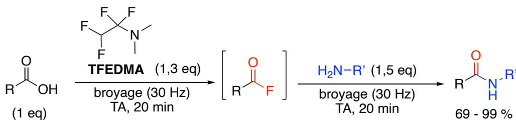
Schéma 7 : Synthèse d'amide et d'ester par mécanochemie
