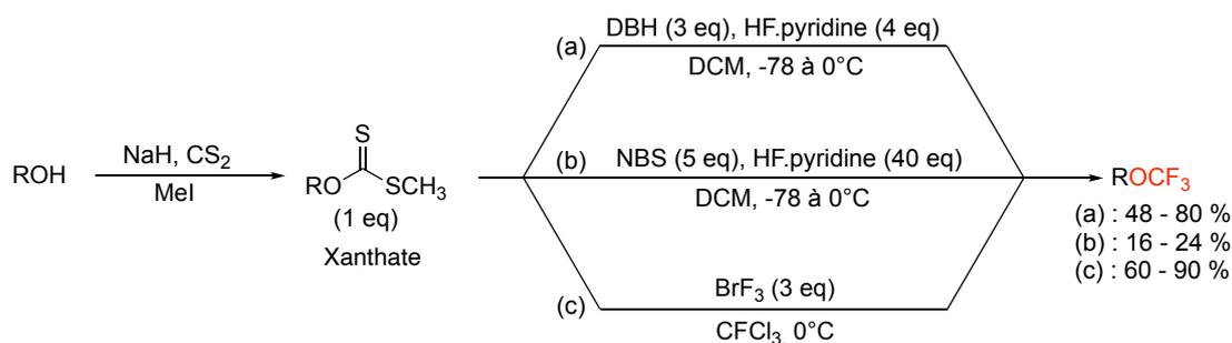
Schéma 8 : synthèse via dithiocarbonate - (a) alcool primaire aliphatique - (b) alcool secondaire aliphatique (c) alcool primaire aliphatique
