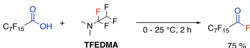
Schéma 25 : Synthèse d'un fluorure d'acide à partir du TFEDMA
