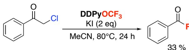
Schéma 1 : Essai de trifluorométhoxylation sur la 2-chloroacétophénone
