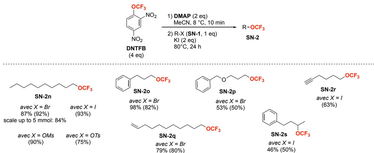
Schéma 4 : Exemplification sur des substrats non activés
