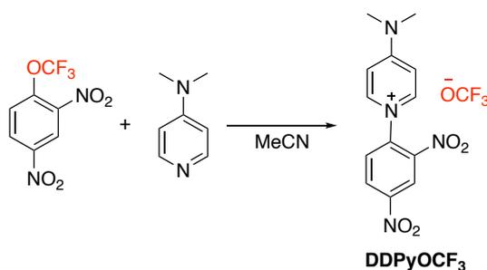
Schéma 4 : synthèse du **DDPyOCF<sub>3</sub>** - Conditions : 1 eq de DNTFB et 0,9 eq de DMAP, TA
