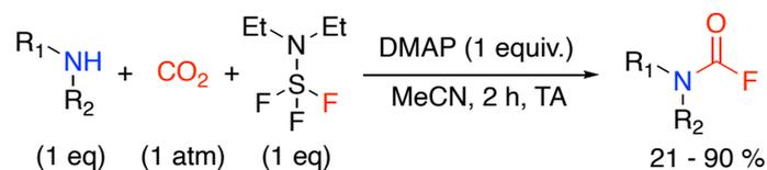
Schéma 5 : Synthèse des fluorures de carbamoyle à partir d'amines secondaires, de CO<sub>2</sub> et d'un réactif de désoxyfluoration.
