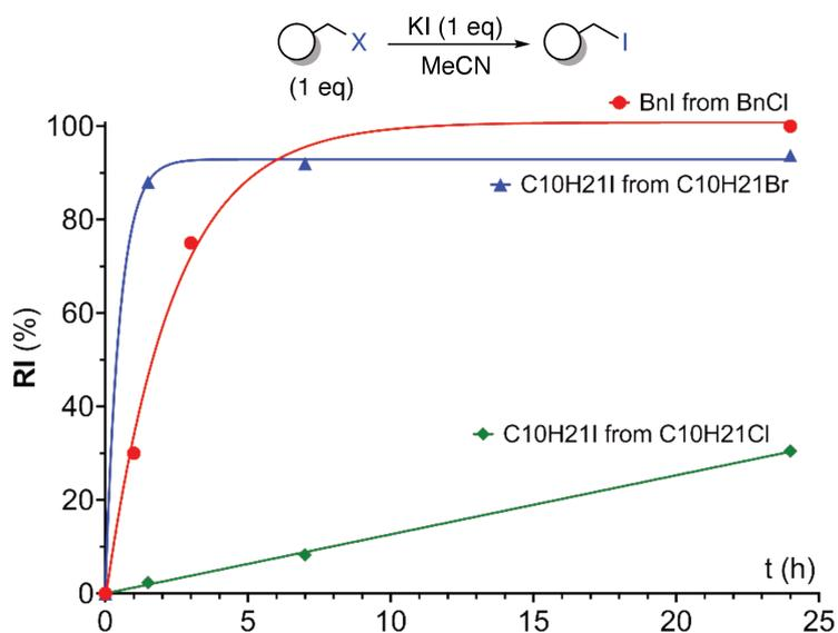
Figure 4 : Étude de la cinétique des réactions de Finkelstein sur le chlorure de benzyle, sur le 1-bromodécane et sur le 1-chlorodécane
