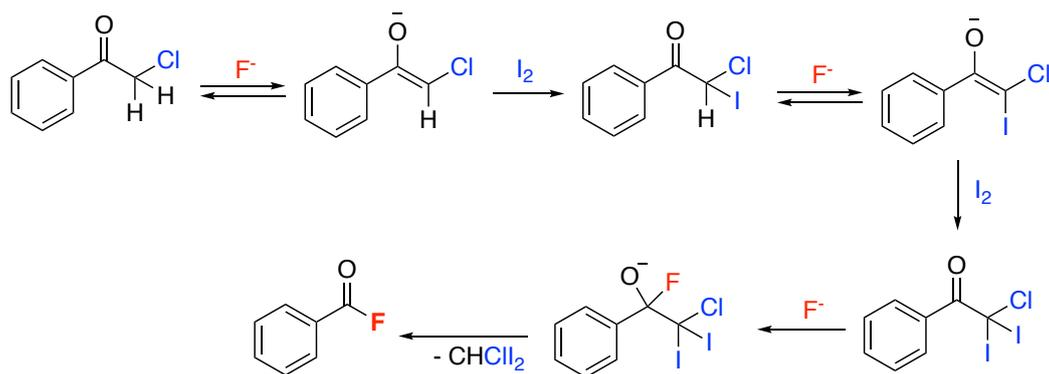
Schéma 2 : Réaction de type haloforme sur la 2-chloroacétophénone
