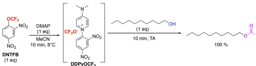
Schéma 9 : Étude de la formation du fluoroformate à partir du decan-1-ol, suivie par RMN <sup>19</sup>F
