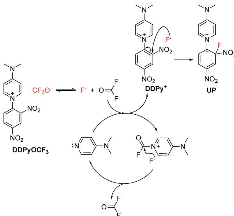
Schéma 10 : Hypothèse mécanistique de la dégradation du **DDPyOCF<sub>3</sub>**
