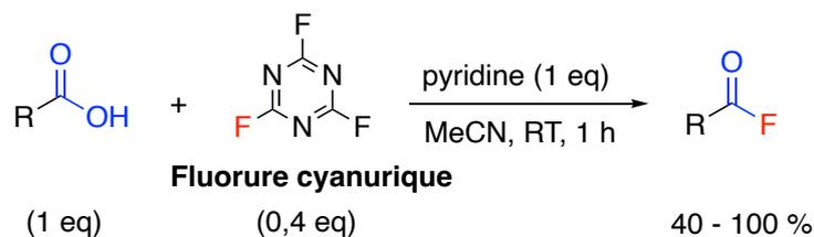
Schéma 21 : Synthèse des fluorures d'acide à partir du fluorure cyanurique
