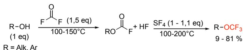
Schéma 7 : utilisation de difluorophosgène et SF<sub>4</sub>
