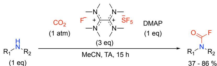
Schéma 9 : Synthèse des fluorures de carbamoyle à partir de CO<sub>2</sub> et d'un réactif contenant SF<sub>5</sub><sup>-</sup>
