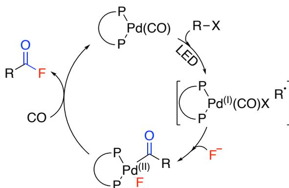
Schéma 15 : Mécanisme de la synthèse des fluorures d'acide par photochimie et catalysée au palladium
