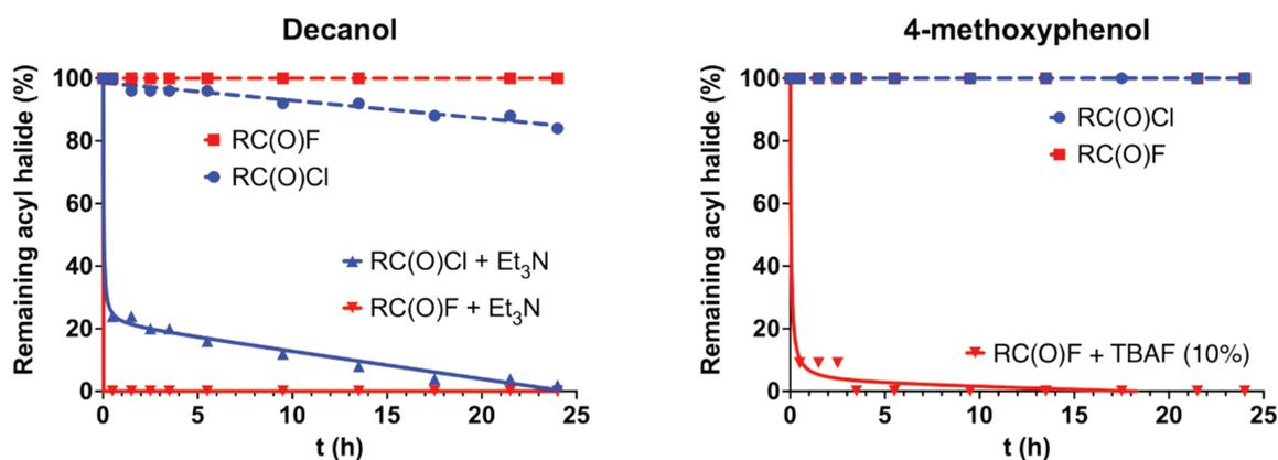
Figure 3 : Réactivité du fluorure d'acide **FA-2d** et de son analogue chloré avec différents alcools - suivi par RMN <sup>19</sup>F avec PhOCF<sub>3</sub> comme étalon – Conditions : a) RCOX (1 eq), Alcool (1 eq) dans CD<sub>3</sub>CN à TA b) RCOX (1 eq), decan-1-ol (1 eq), Et<sub>3</sub>N (1 eq) dans CD<sub>3</sub>CN à TA c) RCOX (1 eq), 4-méthoxyphénol (1 eq), TBAF (10 mol%) dans CD<sub>3</sub>CN à TA
