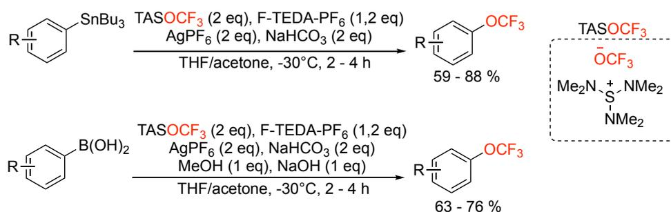
Schéma 38 : Trifluorométhoxylation d'aromatiques avec le TASOCF<sub>3</sub>
