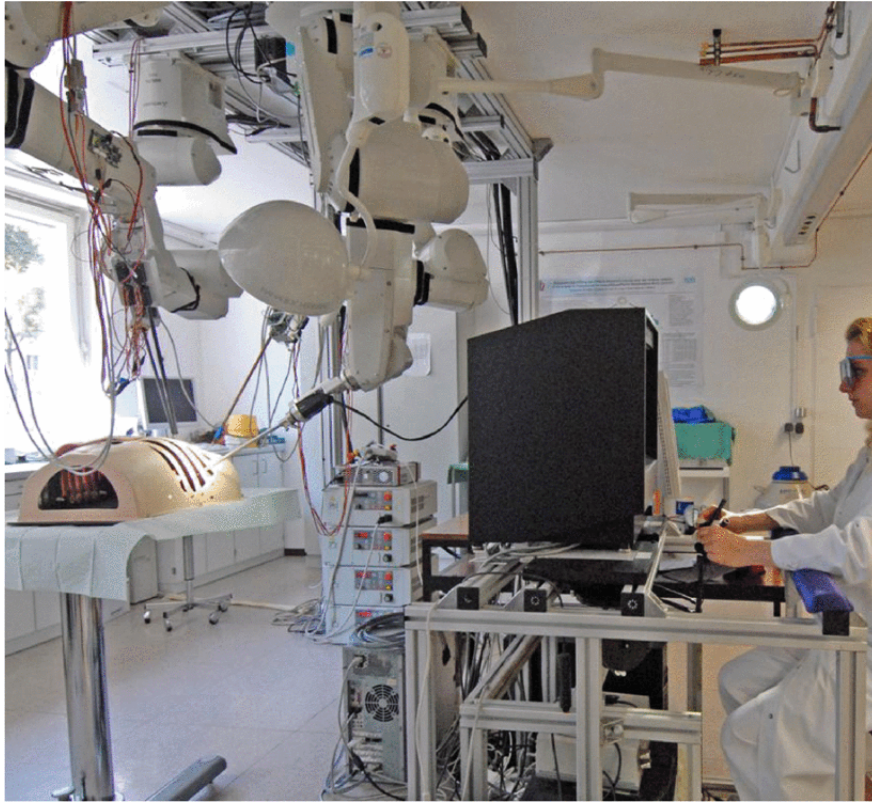
FIGURE 1.8 – Pour une immersion maximale, le chirurgien se trouve devant un écran stéréo et commande le système à l’aide de dispositifs haptiques pilotés par logiciels (STAUB et al. 2012)
