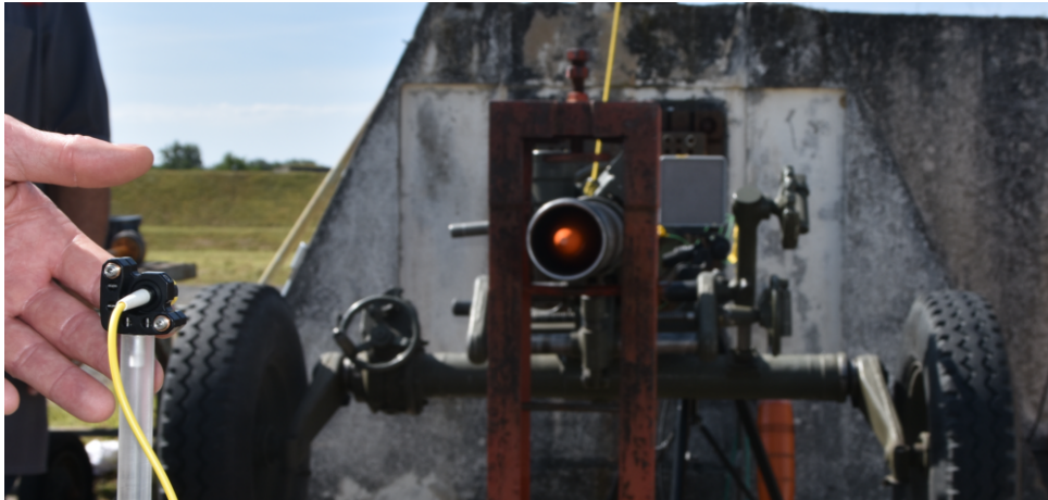
FIGURE 8.2 – Réglage de l'alignement de la tête optique sur la trajectoire du nez de la munition.
