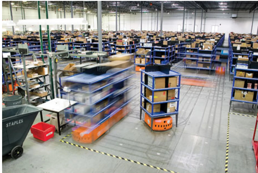
FIGURE 12.2 – La technologie logistique Kiva. Source : Joel Eden Photography/Kiva Systems
