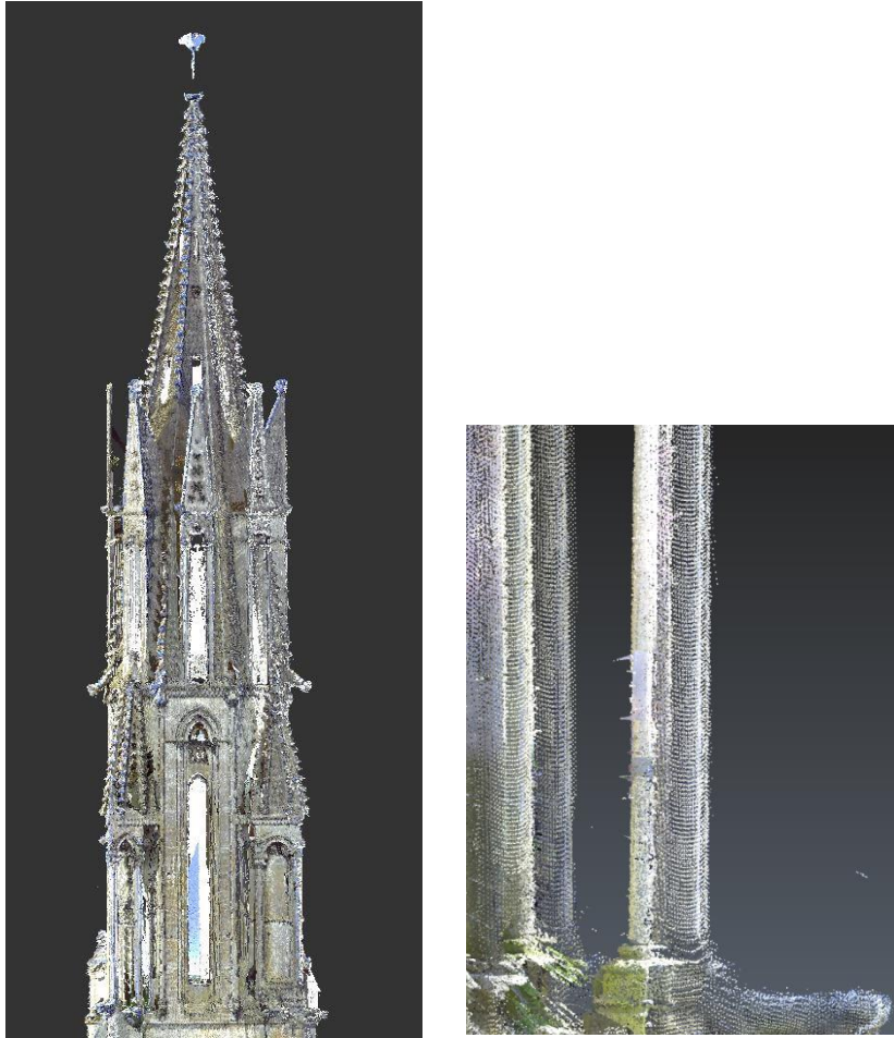
Figure 10 : Nuage de points de la flèche avant traitement, et détail en pied de colonne
