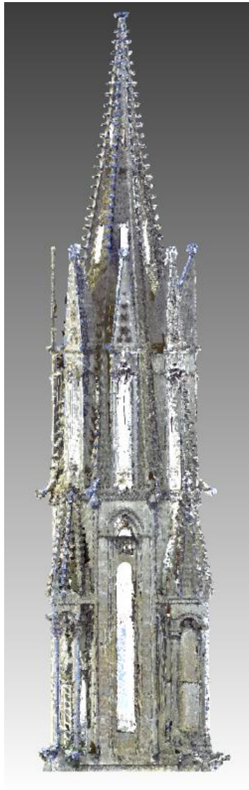
Figure 11 : Nuage de points final après traitements, nettoyage et filtrage, et détail en pied de colonne
