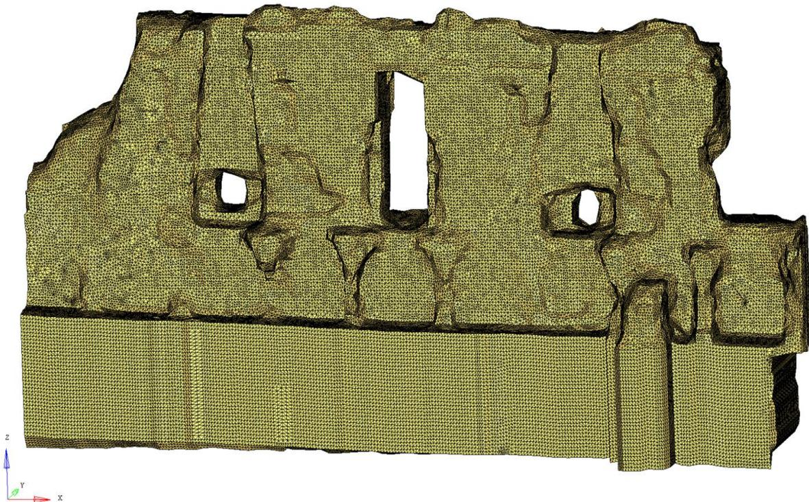
Figure 56 : Maillage tétraédrique du mur de la salle des Preux (taille moyenne des mailles de 40cm)
