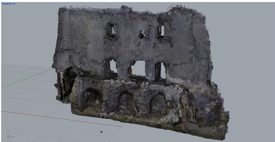
Figure 3 : Modélisation géométrique en voxels d'un mur du château de Coucy
