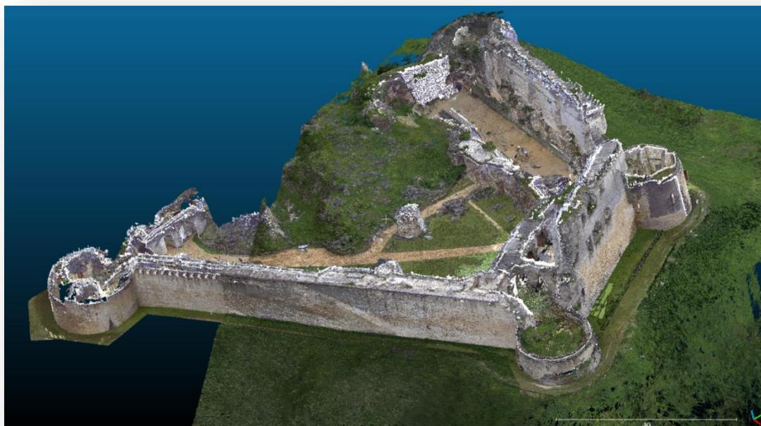
Figure 14 : Nuage de points final après fusion et nettoyage
