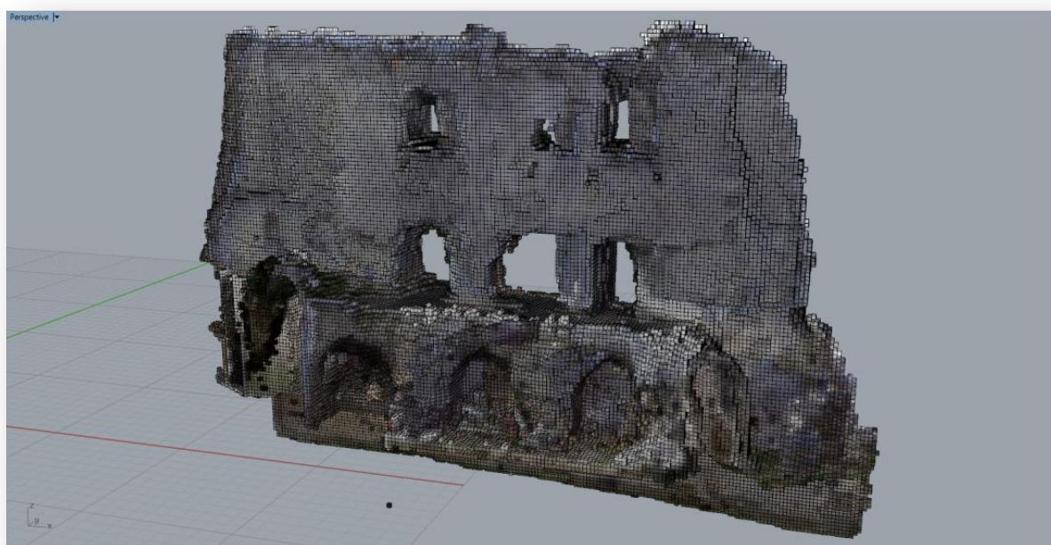
Figure 25 : Géométrie en voxels du mur du Logis avec des éléments de 20cm (284 496 éléments)
