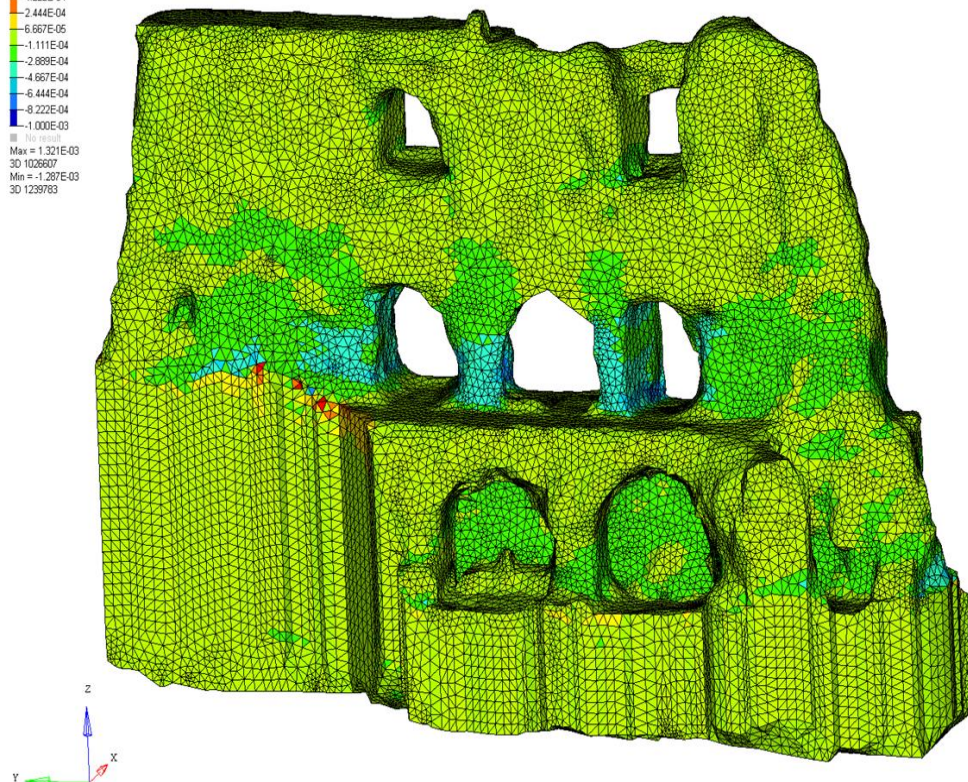
Figure 59 : Contraintes de compression s_{zz} (MPa) dans le mur du Logis (cas du poids propre)
