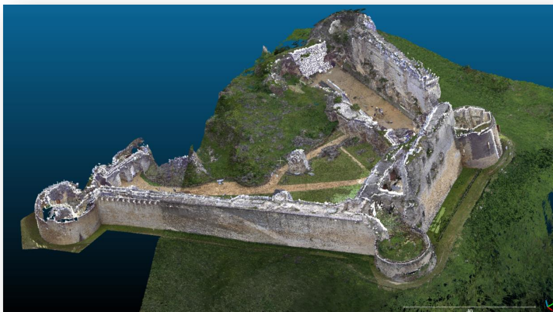
Figure 14 : Nuage de points final après fusion et nettoyage
