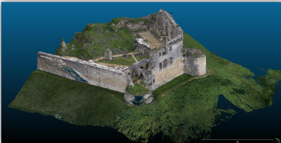
Figure 13 : Nuage de points issu de la photogrammétrie
