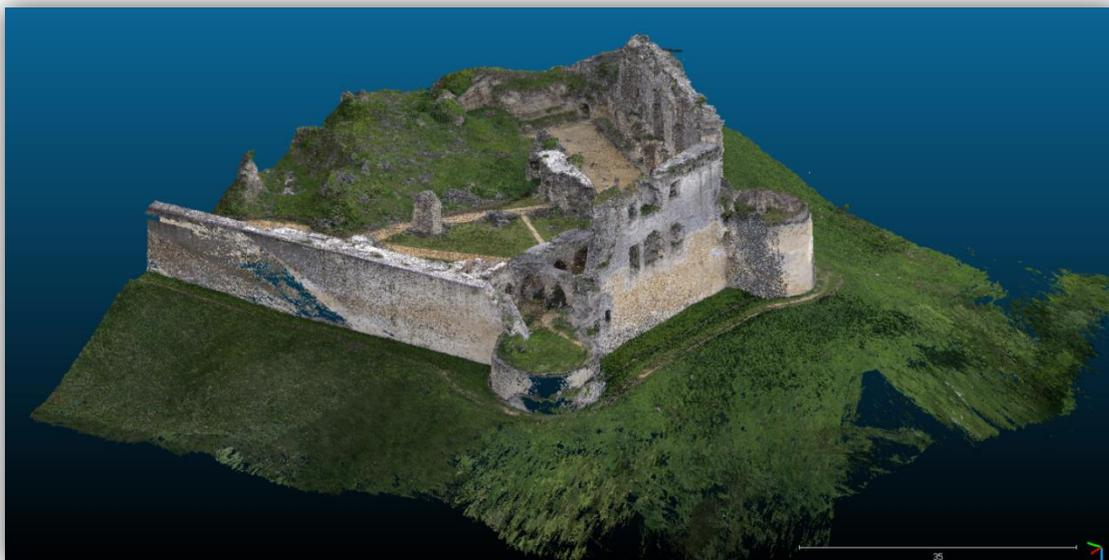
Figure 13 : Nuage de points issu de la photogrammétrie
