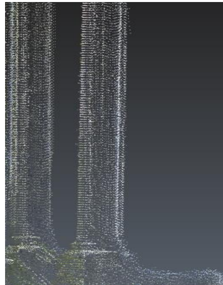
Figure 11 : Nuage de points final après traitements, nettoyage et filtrage, et détail en pied de colonne
