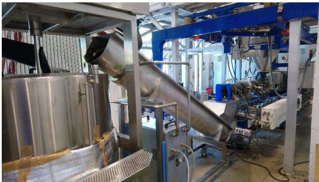
Figure 41. Couplage extruder bivis et bioréacteur à l'échelle pilote
