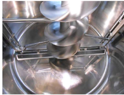
Figure 40. Vis sans fin de convoyage et bioréacteur de 300 litres pour les expériences à l'échelle pilote.
