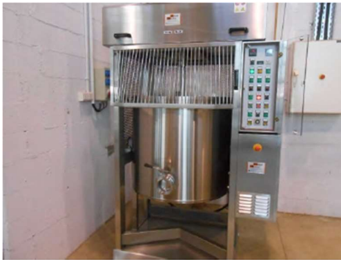
Figure 40. Vis sans fin de convoyage et bioréacteur de 300 litres pour les expériences à l'échelle pilote.
