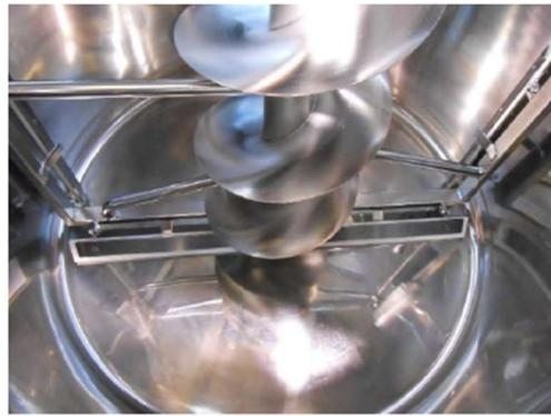
*Figure 40. Vis sans fin de convoyage et bioréacteur de 300 litres pour les expériences à l'échelle pilote.*
