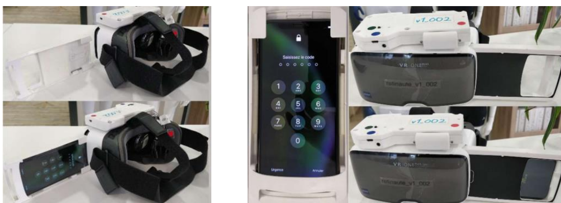
Figure 42. Photographies du téléphone associé au Retinaute® (Version 1.0). La stimulation damiers (PERG/PEEG) est réalisée au moyen d'un téléphone portable (Apple, iPhone XS) placé à l'intérieur du dispositif. Le damier alternant est généré grâce à une application mobile qui communique avec l'ordinateur de l'étude via une connexion Bluetooth.
