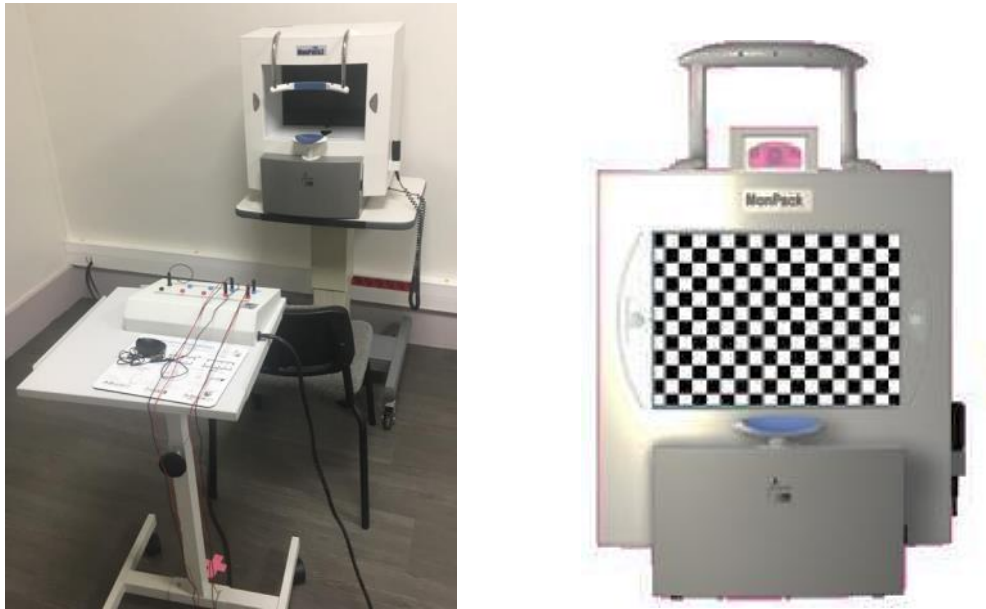
Figure 45. Photographies du MonPackOne® de Metrovision, figure tirée de https://metrovision.fr . Le dispositif comprend un boîtier de stimulation et de branchement des électrodes (gauche) dans lequel est projeté des stimulations visuelles sous la forme de flashes ou de damiers alternants (droite). Le participant s'assied sur la chaise en face de la boîte rectangulaire et vient placer sa tête sur la mentonnière bleue prévue à cet effet. Il visualise les flashes ou les damiers alternants projetés à l'intérieur de la boîte. Le recueil des signaux ERG est effectué au moyen d'électrodes cutanées ou d'électrodes Dawson, Trick and Litzkow (DTL).
