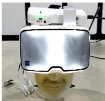
Figure 41. Photographie de la stimulation flash du Retinaute® (Version 1.0). Les stimulations flashes pour les examens fERG et fEEG sont générées par le biais de modules LED lumineux directement intégrés au dispositif et situés sur le pourtour des yeux du participant. L'expérimentateur décide quand démarre l'examen fERG ou fEEG grâce au logiciel présent sur l'ordinateur de l'étude qui communique avec le Retinaute® via une communication Bluetooth.
