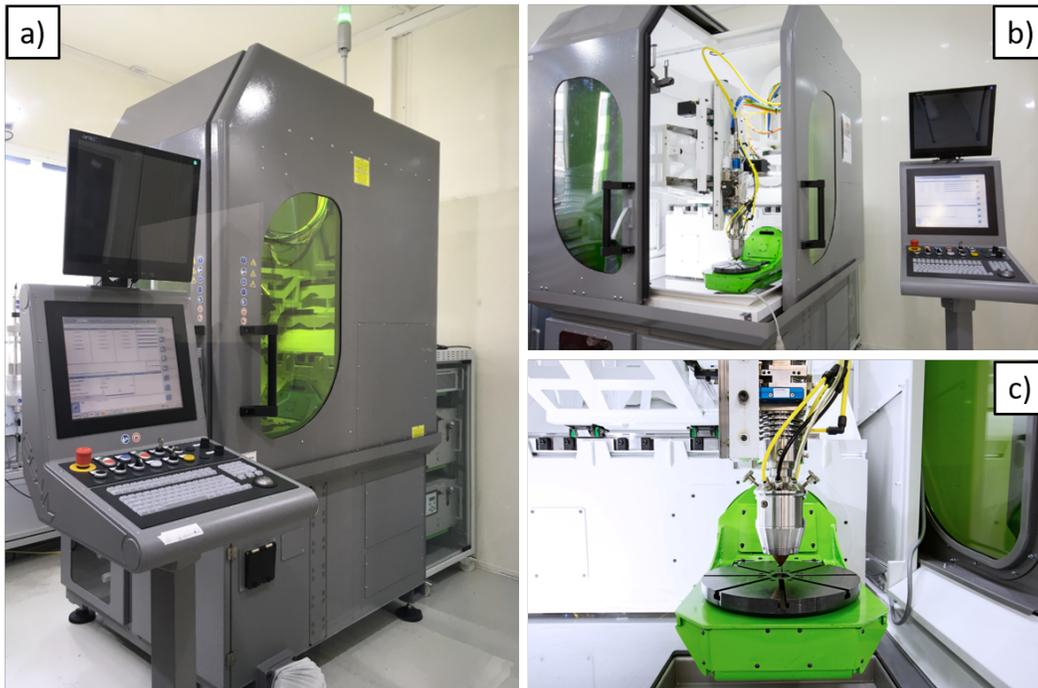
FIGURE 2.5 – (a-b) Photographies d'ensemble de la machine d'impression BeAM Mobile-004 et (c) de la zone d'impression à l'intérieur de la machine.
