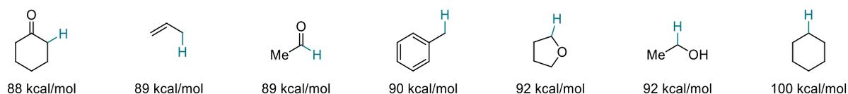
Figure 2 BDE de quelques liaisons C-H
