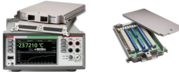
FIGURE 4.9 – Keithley DAQ6510 utilisé pour l'acquisition des données.
