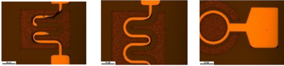
FIGURE 2.5 – Adhérence/décollement partielle de la grille platine pour une couche de 30nm d'épaisseur.
