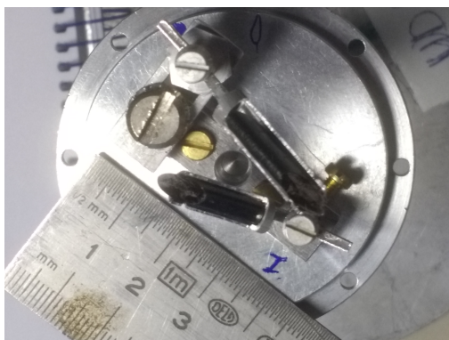
FIGURE 3.16 – Vue du dessus de deux cristallites co-alignées de \text{Sr}_2\text{CuO}_3 , mesurées sur IN8.
