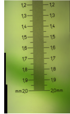
(b) Reconstruction de l'image de l'étalon, avec trois tuiles au grossissement x20
