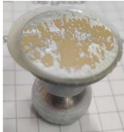
Figure 4-50 : Sur la gauche une capsule ayant subi le test d'arrachement et sur la droite le plot utilisé pendant la manipulation. On peut voir sur la photo de gauche que le vernis a bien été transféré sur le plot, mettant à nu le métal. Sur la photo de droite, le vernis (en jaune) est le négatif du métal mis à nu.
