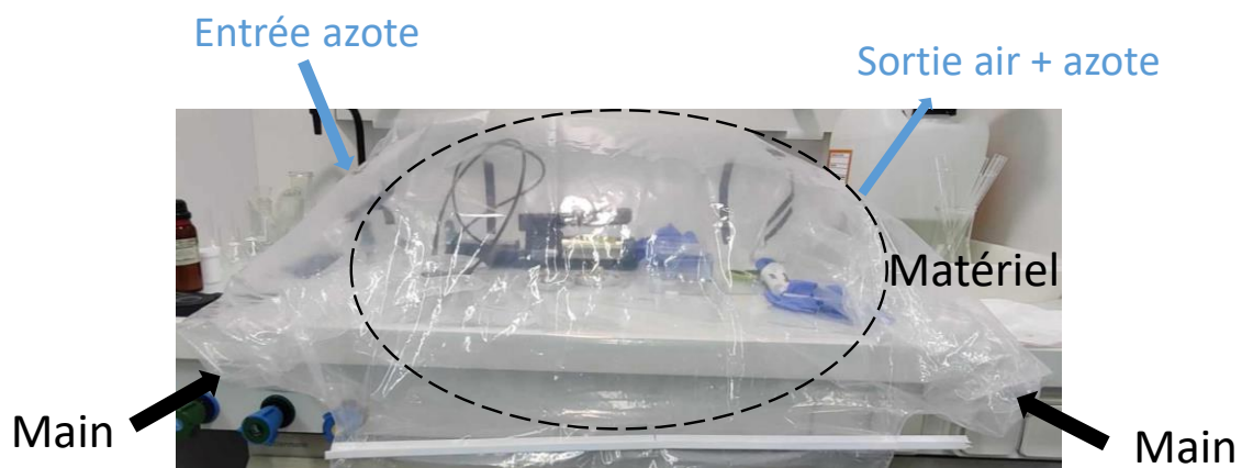
Figure 4-46 : photo du sac à gants et annotation pour le principe de fonctionnement
