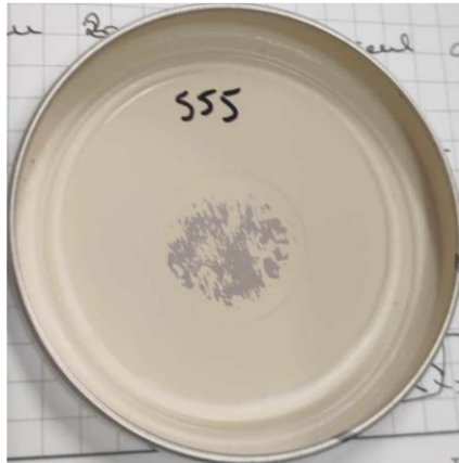
Figure 4-50 : Sur la gauche une capsule ayant subi le test d'arrachement et sur la droite le plot utilisé pendant la manipulation. On peut voir sur la photo de gauche que le vernis a bien été transféré sur le plot, mettant à nu le métal. Sur la photo de droite, le vernis (en jaune) est le négatif du métal mis à nu.
