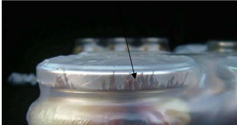
Figure 1-10 : Photo d'un bocal de poivron emballée par un film plastique trop hermétique où l'on peut apercevoir le délaminage du vernis
