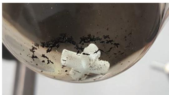
**Figure 166** – Décomposition des nanoparticules de palladium après catalyse.
