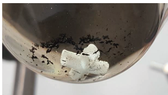
Figure 166 – Décomposition des nanoparticules de palladium après catalyse.
