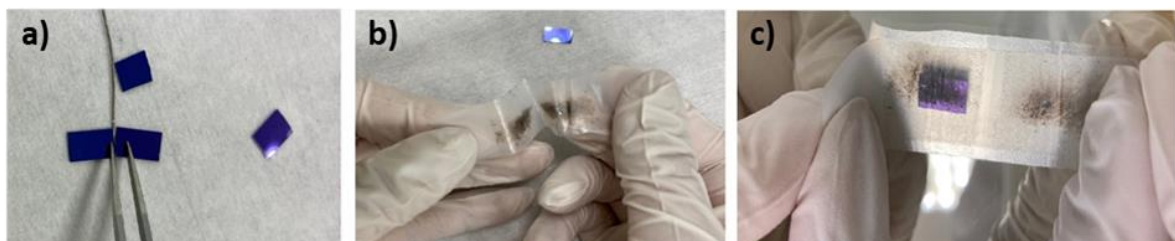
Figure 1.11 : Images optiques du procédé d'exfoliation mécanique d'un 2D. (a) Découpe et préparation des échantillons hôtes ( \text{SiO}_2 sur Si) (b) Amincissement des cristaux en repliant le scotch sur lui-même à plusieurs reprises (c) Dépôt de la poudre de cristaux sur un scotch adhésif
