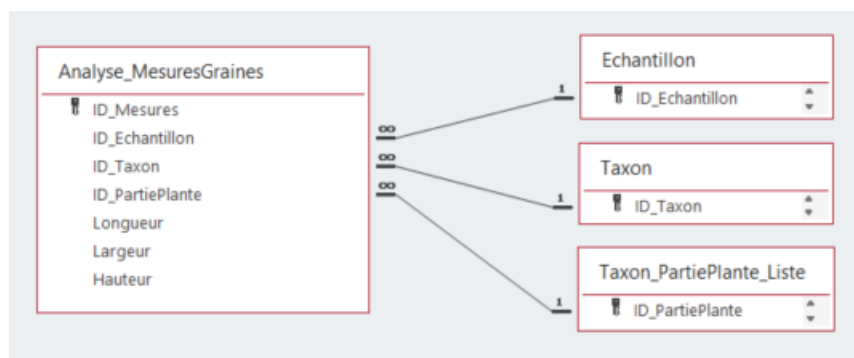
Fig. 10 - Schéma relationnel simplifié de la table « Analyse_MesuresGraines ». Seules les relations directes sont affichées.
