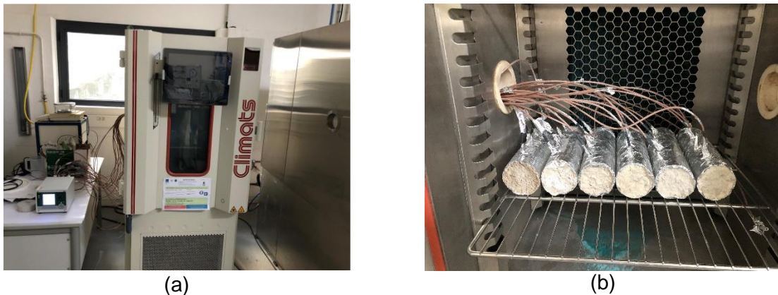
Figure 13. Dispositif expérimental pour l'étude de cas de transferts hydriques en régime instationnaire : (a) enceinte climatique Excal 2211-HA de climats, (b) échantillons (référence et bio-composite MCP) cylindriques (8 cm de diamètre et 20 cm de hauteur) avec faces isolées et emplacement des capteurs.
