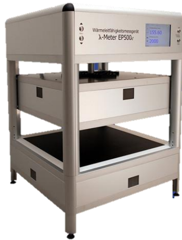
Figure 7. Dispositif \lambda -Meter Ep500e® utilisé pour la mesure de la conductivité thermique - LaSIE.
