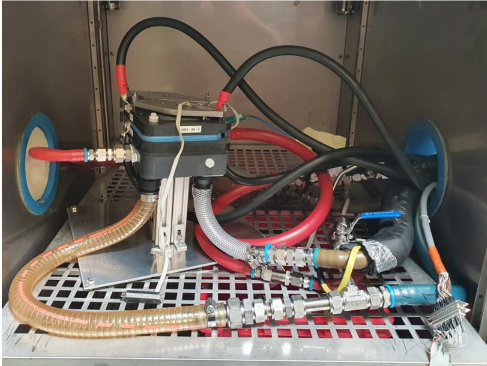
Figure 77- PEMFC 5 cellules dans la chambre thermique pour la campagne d'essai n°2
