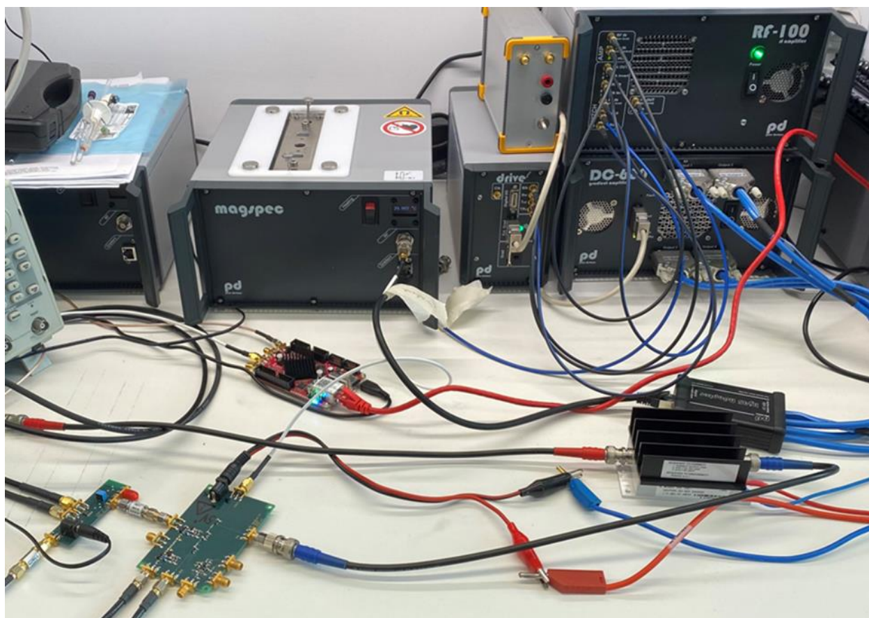
Figure 15 : Notre prototype de spectromètre RMN dans l'état actuel étant utilisé conjointement avec le spectromètre RMN de type Benchtop de la société Pure Devices.
