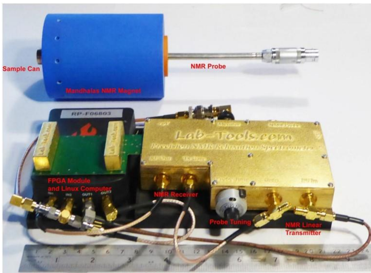
Figure 3 : Spectromètre RMN à relaxation Lab-Tools Mk3 avec un Red Pitaya STEMLab 125-14.
