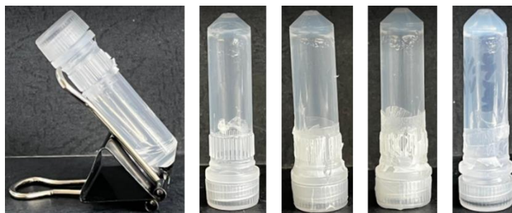
Figure 107 : Echantillons de gels issus du NL 292 1,5-amide-ester de 1 % m/m à 5 % m/m (de la gauche vers la droite)
