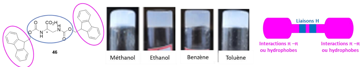
Figure 33 : a) Gels du peptide ambidextre 46 à 1 % m/m b) Structure de type haltère 194
