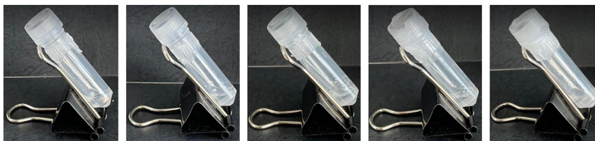
Figure 115 : Echantillons issus du NL 304 1,4-ester-amide de 1 % m/m à 5 % m/m dans le Miglyol 812N ® (de la gauche vers la droite)
