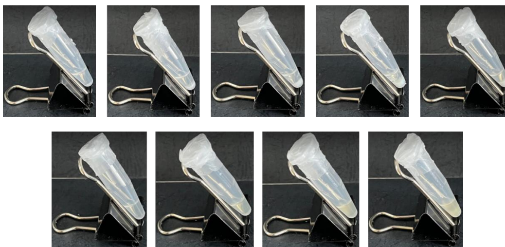
Figure 84 : Photos des essais de solubilisation des NLs greffés par un 2-méthylnaphtalène (haut) et un indole (bas) dans le Miglyol 812N ® de 1% à 5% m/m (de la gauche vers la droite)
