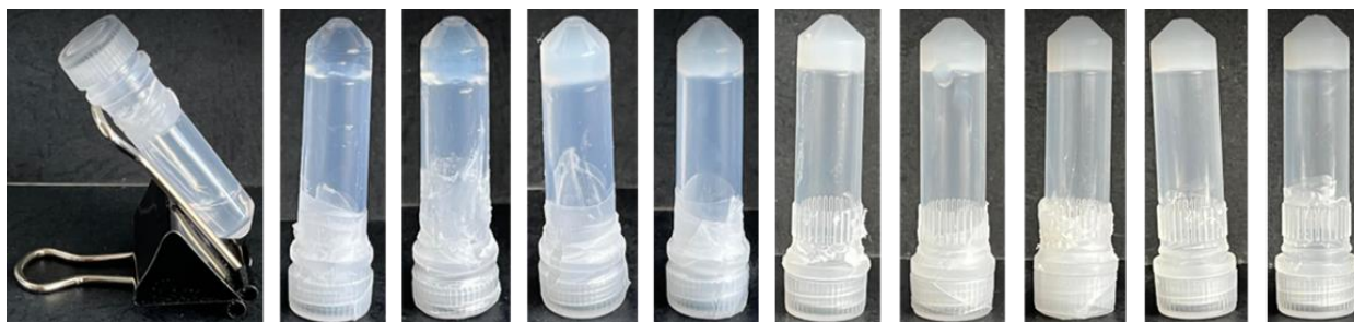
Figure 109 : Gels issus du NL 298 1,4-amide-ester propylé en position 3' de 1 % m/m à 10 % m/m (de la gauche vers la droite)
