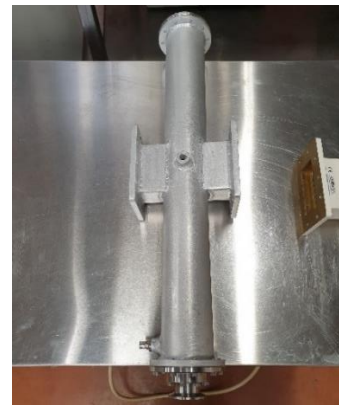
Cavité micro-ondes pour préchauffage du solvant avant entrée dans le module de régénération
