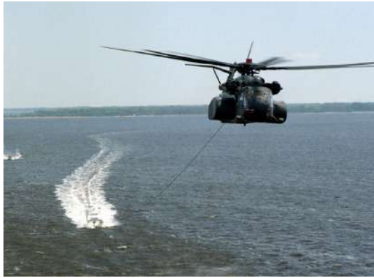
Figure 2.4. : Hélicoptère tractant une drague.
