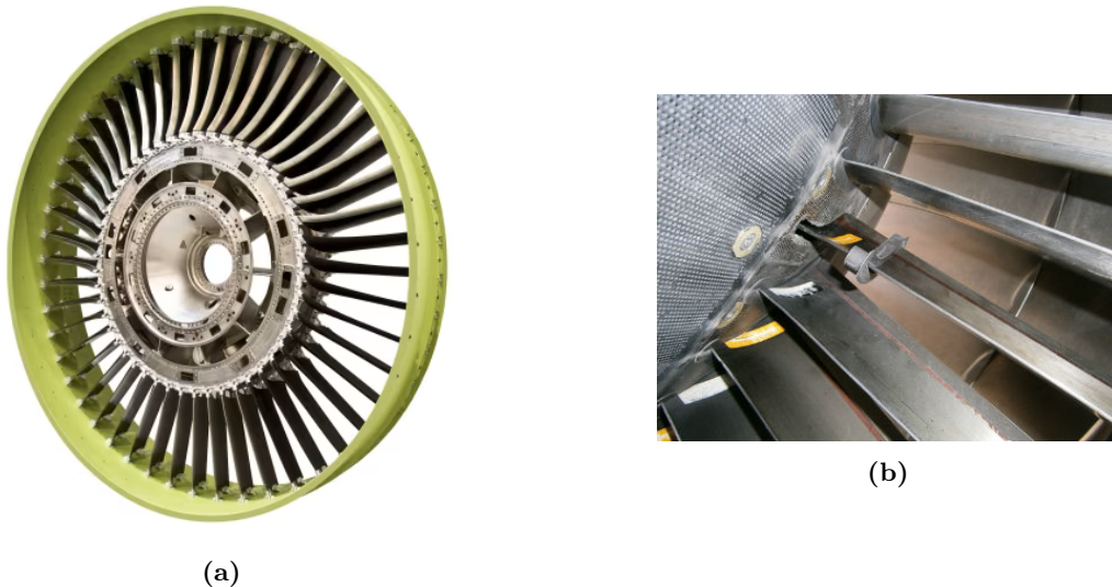
Figure 3.28. OGV (Outlet Guide Vane). (a) : Vue complète; (b) : Zoom sur la grille.
