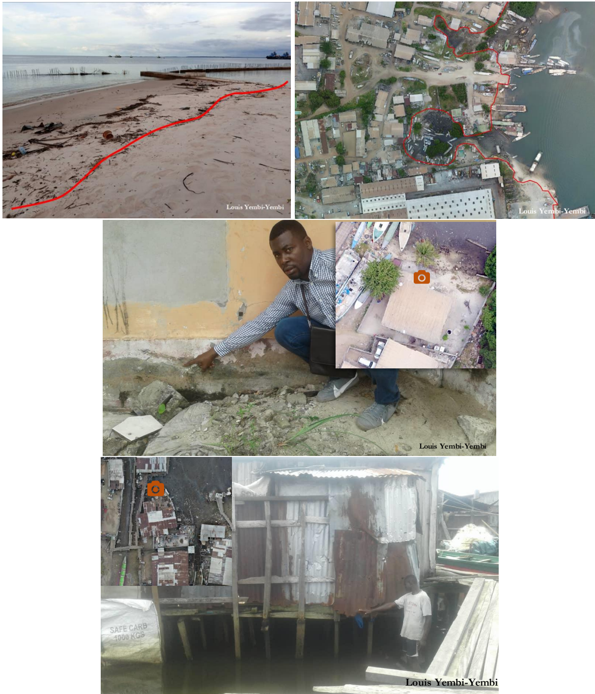
Figure 3-27 : Illustration des marquages physiques utilisés sur le terrain pour délimiter la limite des plus hautes eaux identifiées sur le terrain image du haut à gauche (photo prise le 5 février 2019 à 17h30) et par orthophoto drone sur l'image en haut à droite, ainsi que les hauteurs à certains points (quartier Matanda).
