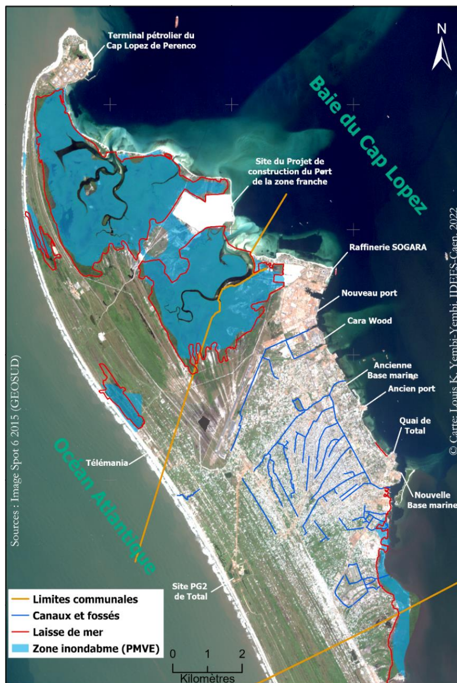
Figure 3-26 : Intersection de l'étendue des zones inondables par la mer (zone bleue) à partir du PMVE et la limite de la laisse de mer (Trait rouge). (Réalisation L. YEMBI, 2022)
