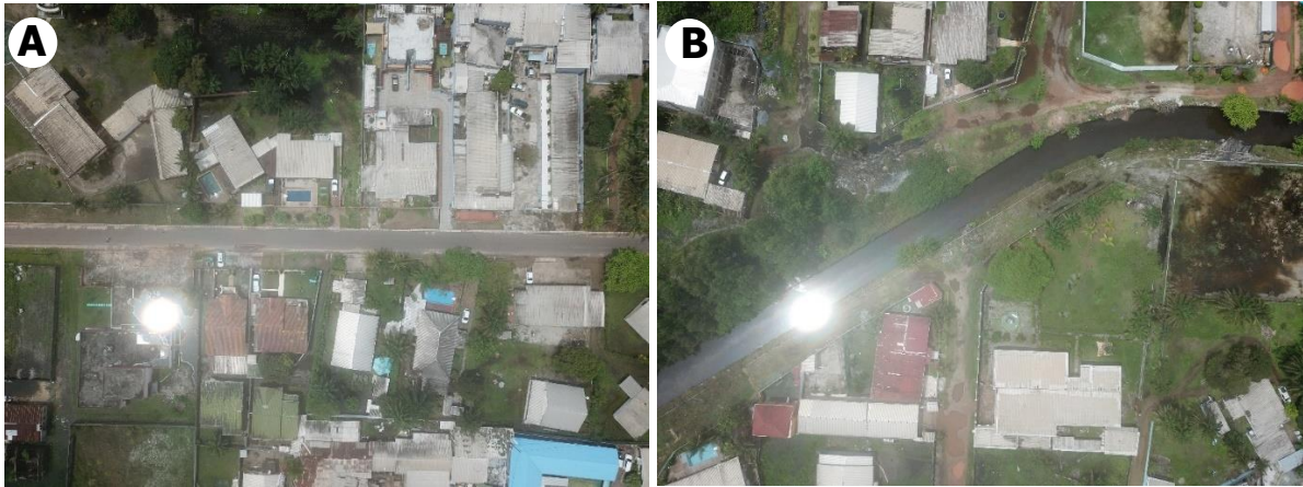
Figure 3-15 : Phénomène de réflectance de la luminosité sur les toitures des bâtiments en aluminium (A) et sur des plans d'eau (B).
