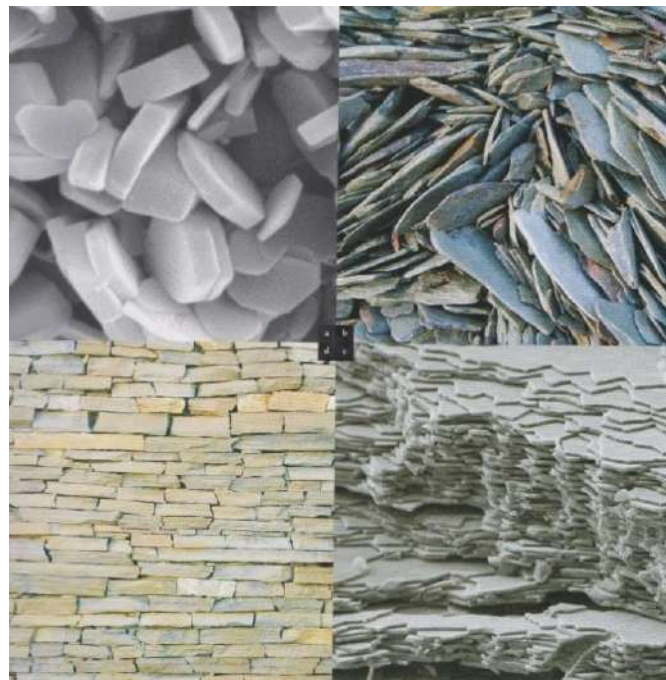
Fig. 44. Structure des biominéraux : (a) les plaquettes d'argile empilées de manière aléatoire (b) un tas de pierres plates, (c) les plaquettes d'aragonite de nacre bien organisées (d) un mur en pierres sèches. (Anger,2009 : 211)
