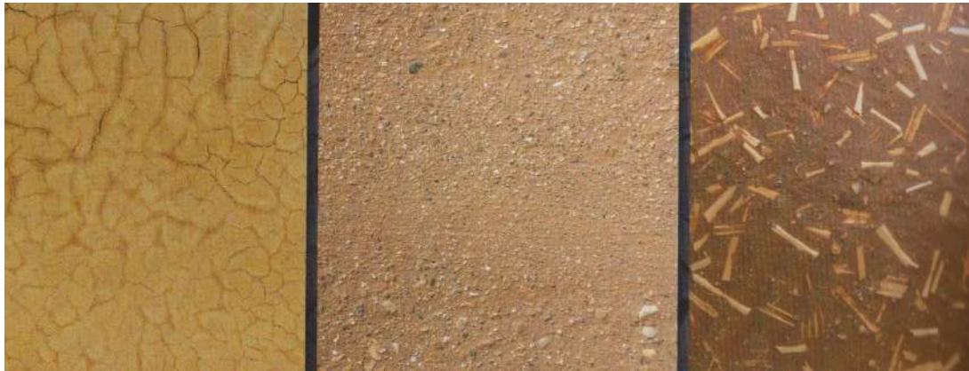
Fig. 35. États d'argiles avec stabilisants, de gauche à droite : argile simple, argile avec sable, argile avec paille. (Fontaine et Anger,2009 :162)
