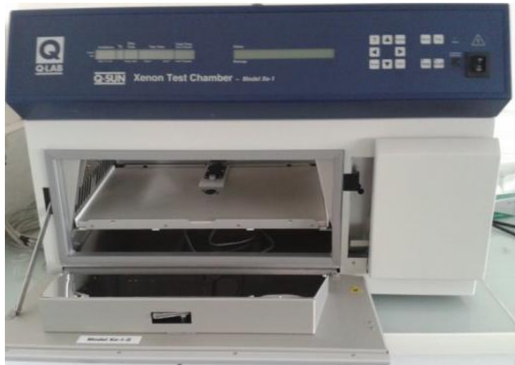
Figure II-5 : Enceinte de vieillissement accéléré Q-SUN
