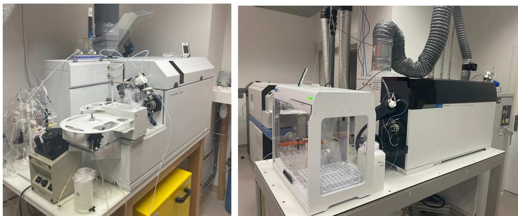
Figure 8. Photos des ICP-MS utilisées dans cette thèse. A gauche : l'Agilent ICP-MS-7500. A droite : l'Agilent ICP-MS-QQQ-8900.
