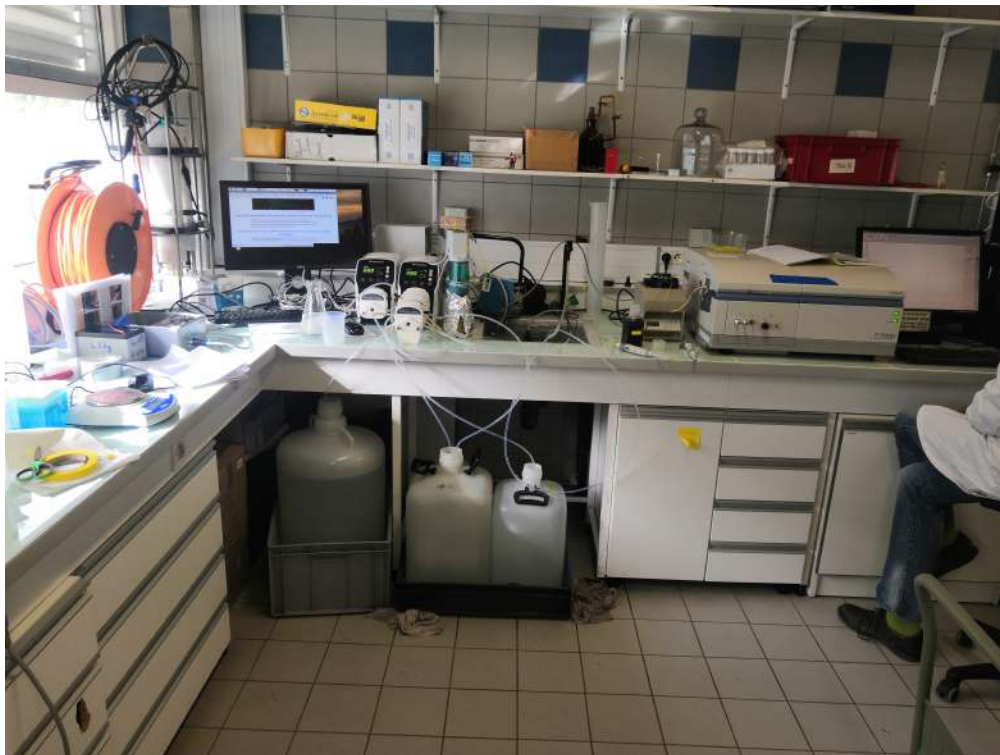
FIGURE 4.13 – Photo du Dispositif expérimental pour l'acquisition de données de fluorescence en ligne.
