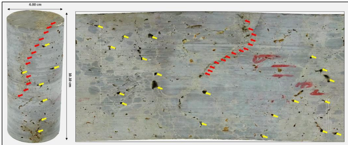
Figure 46. Image 3D (à gauche) et orthoimage (à droite) d'un échantillon de 4 cm de diamètre du faciès C. Les flèches rouges mettent en évidence les fractures et fissures, les flèches jaunes mettent en évidence les cavités de dissolution.
