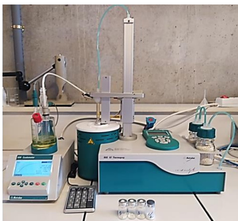
Figure 82 : Titreur coulométrique, Karl Fischer
