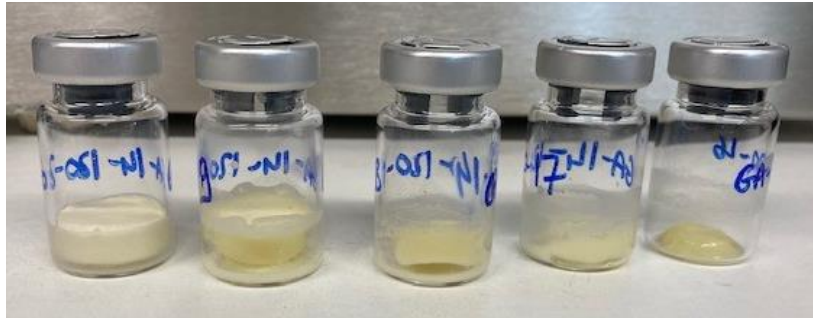
Figure 94 : Photo des lyophilisats de l'essai 1. De gauche à droite : concentrations massique initiale de 50%, 40%, 30%, 20% et 12%.
