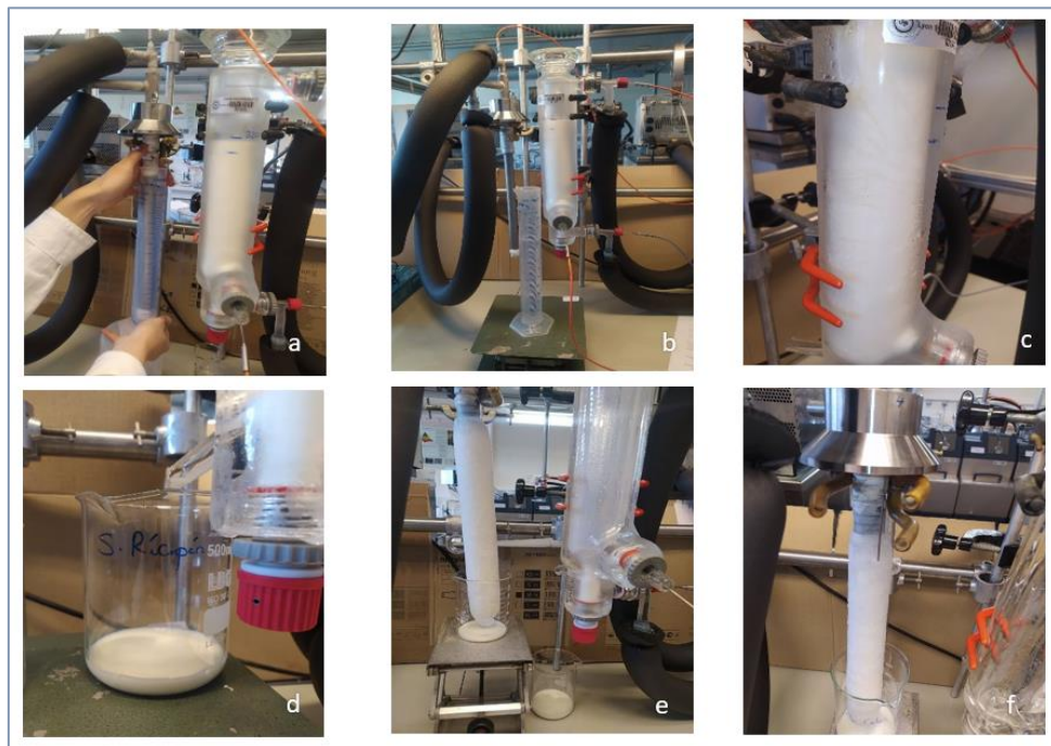
Figure 51 : Etapes du procédé expérimental (a, b : ensemencement du doigt de gant ; c : croissance de la glace ; d : vidange de la solution cryo-concentrée ; e : ressuage ; f : fusion de la couche de glace)
