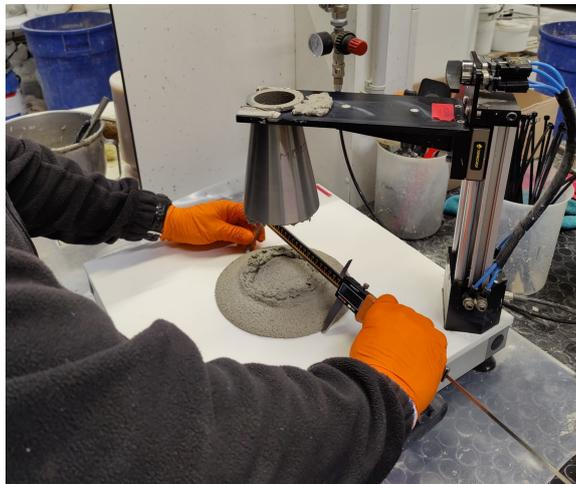
**FIGURE 12.8** Essai d'étalement sur table : mesure du diamètre de la galette d'étalement
