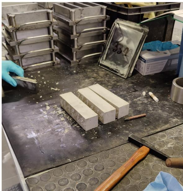
**FIGURE 12.10** Photo des barrettes de mortier après démoulage, 24 h après le gâchage
