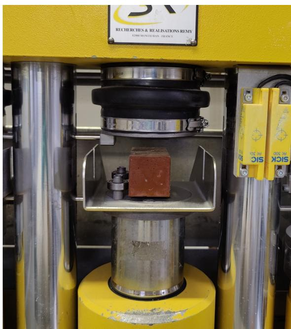
**FIGURE 12.11** Essai mécanique en compression sur une demi-barrette de mortier
