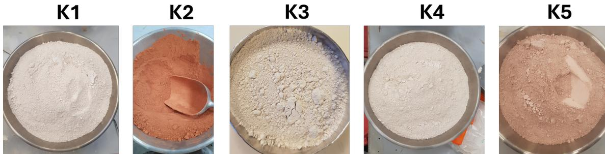
FIGURE 6.1 Photos des kaolins K1, K2, K3, K4 et K5 broyés finement
