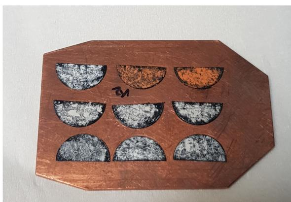
FIGURE 9.5 Porte-échantillons pour les mesures de spectres XANES
