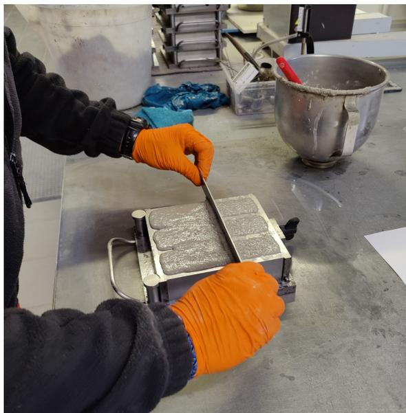
**FIGURE 12.9** Mise en place du mortier dans les moules après gâchage
